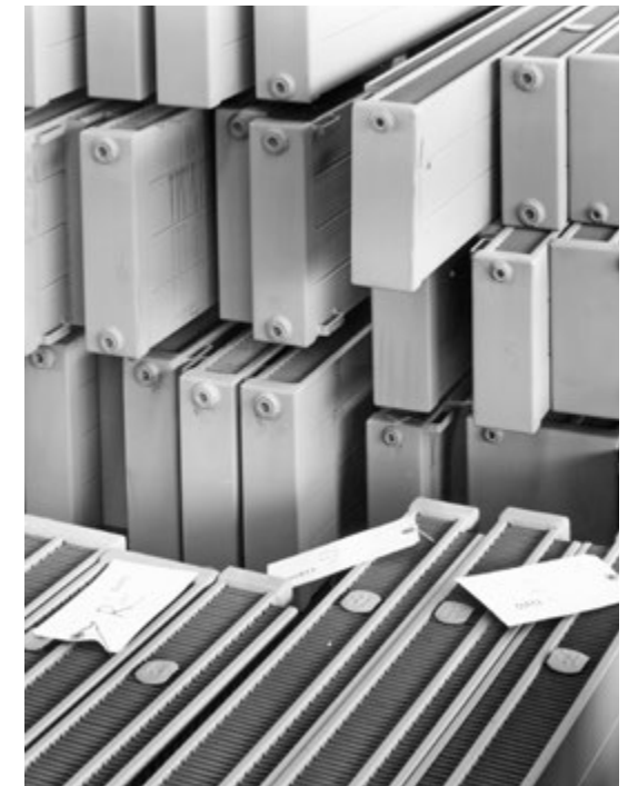
Die Zehnder-Konvektoren sind Heizkörper in niedriger Bauhöhe (7 bis 35 cm). Zwischen den wasserführenden Flachrohren sind Lamellenbahnen zur Oberflächenvergrösserung angepunktet, die eine Konvektion (Kamineffekt) der erwärmten Luft bewirken.
